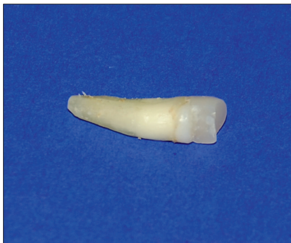
Ryc. 5. Próbkę z endokoroną – linia złamania przebiega w części koronowej na granicy odbudowy i tkanek zęba.
